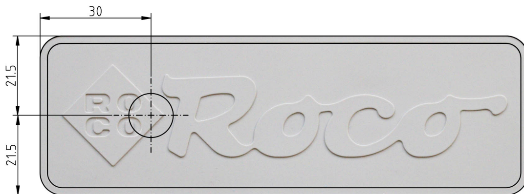
Figuur 8: Plaats voor de opening voor de magneethouder
