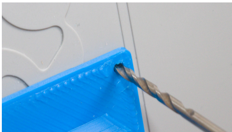
Figuur 11: Gaatjes boren voor de sensormodule
