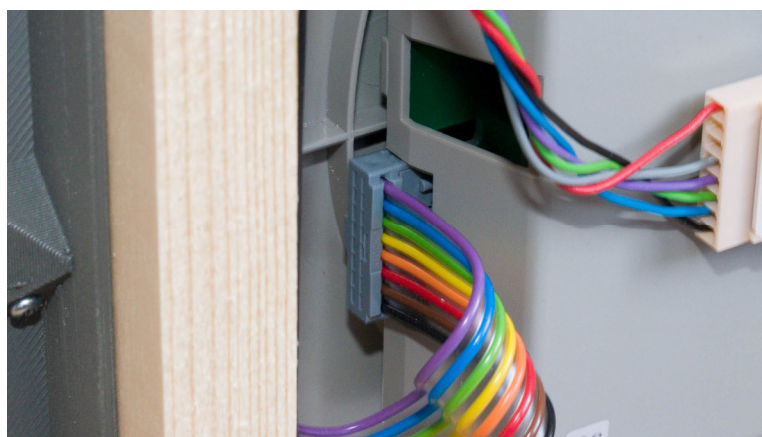
Figuur 15: Aansluiting bandkabel op draaischijf
